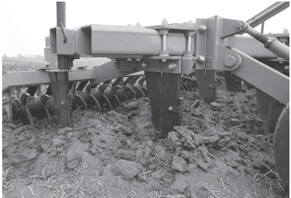
Глубина рыхления почвы чизельным плугом достигает 45 см
