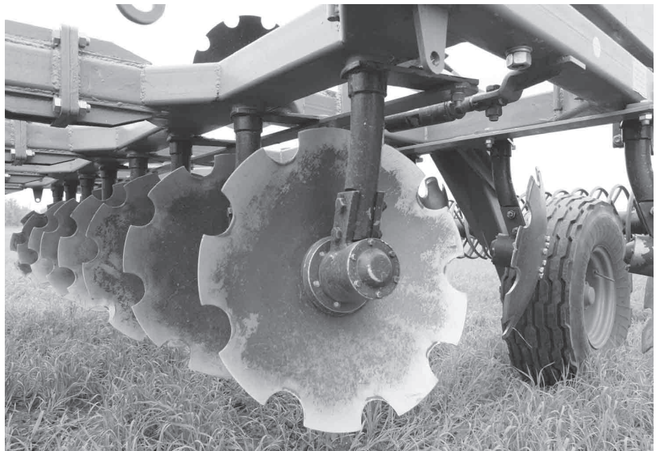
Прорезные диски бороны обеспечивают разделку дерна и целинных земель
