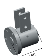
Корпус подшипника Р33.25.30.100 СБ М = 10,2 кг
