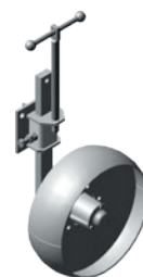
Механизм заднего колеса Р33.06.000-05 М = 61,3 кг
