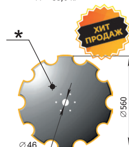
Борона зубовая БЗС-1,00.000-01 (для жёсткой сцепки) М = 33,6 кг
