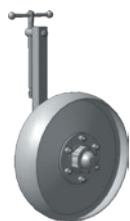
Механизм переднего колеса Р33.08.000-03 М = 94 кг
