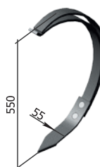
Стойка КПЦ-190 с лапой РК-7 М = 4,89 кг
