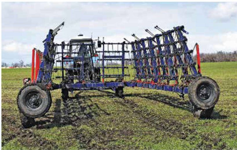
Перевод из рабочего положения в транспортное и обратно выполняется одним трактористом с помощью гидравлического привода
