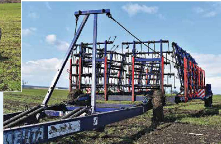
Перевод из рабочего положения в транспортное и обратно выполняется одним трактористом с помощью гидравлического привода
