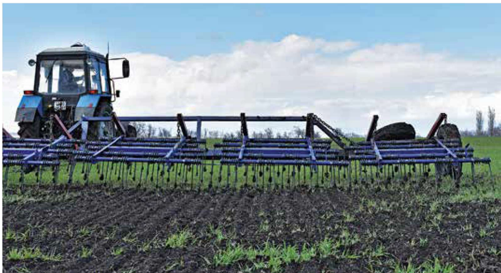
Гибкий подвес секций бороны и их небольшая ширина обеспечивают хорошее копирование почвы
