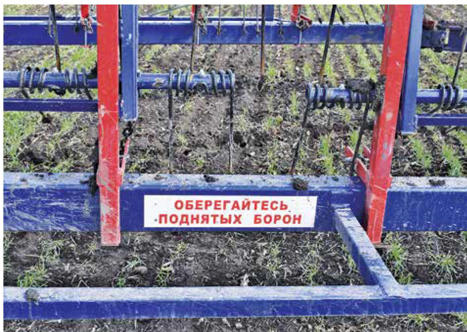
Гибкий подвес секций бороны и их небольшая ширина обеспечивают хорошее копирование почвы
