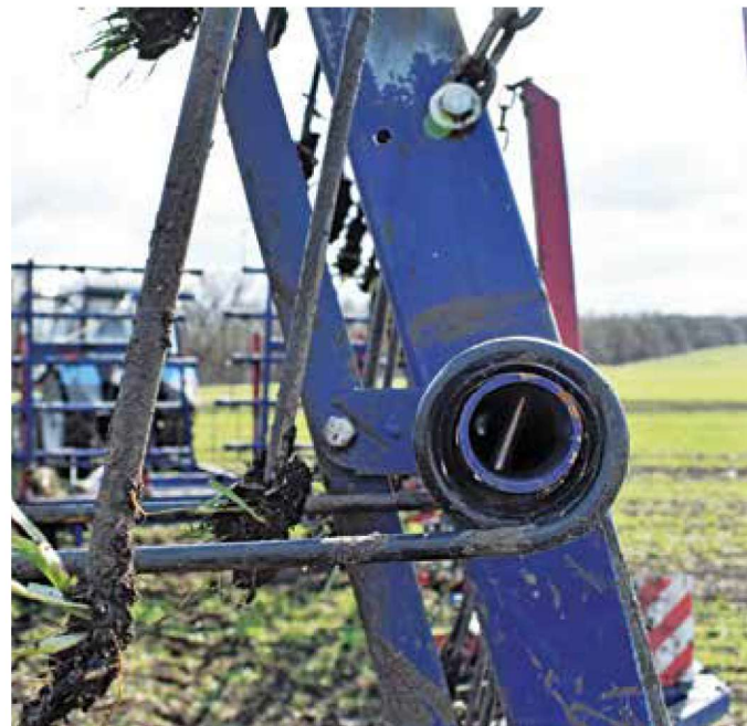
Пружинные зубья крепятся с помощью специальных кованых болтов, преимущество которых является высокая прочность и свободная посадка зуба
