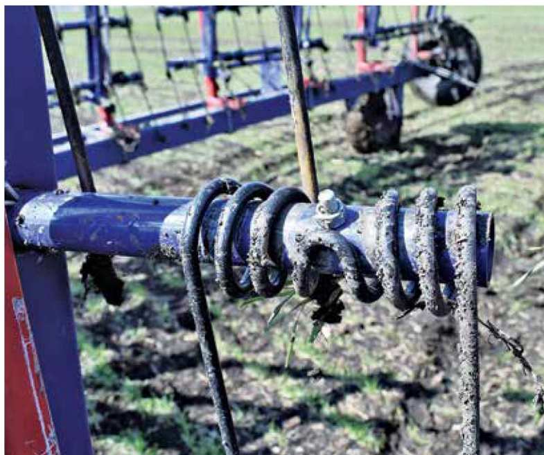
Пружинные зубья крепятся с помощью специальных кованых болтов, преимущество которых является высокая прочность и свободная посадка зуба
